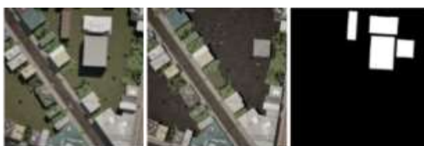
Рис. 2. Пример синтетически сгенерированной пары изображений и маски изменений для задачи Change Detection.
