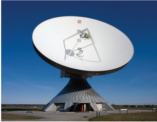
Նկ. 14. Պարաբոլային ուղղվածությամբ արբանյակային անտենա:
