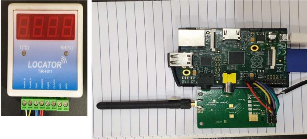
*Рисунок 5. Датчик влажности и температуры (левая панель) и шлюз (правая панель).*
