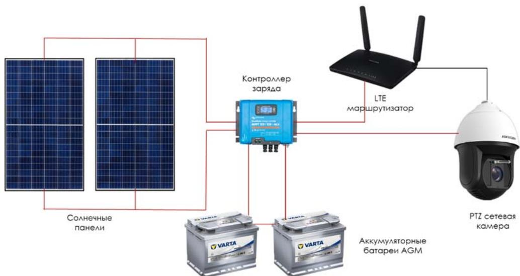
Рисунок 1. Схема подключения станции (станция с поворотной камерой).
