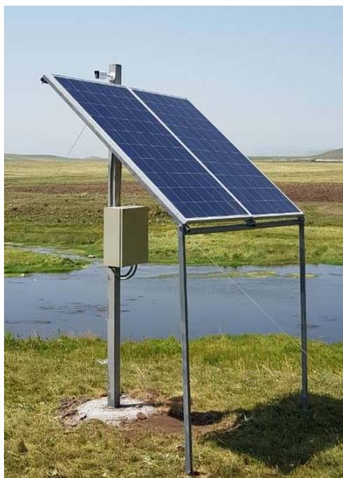
*Рисунок 3. Установленная автономная станция видеомониторинга окружающей среды.*
