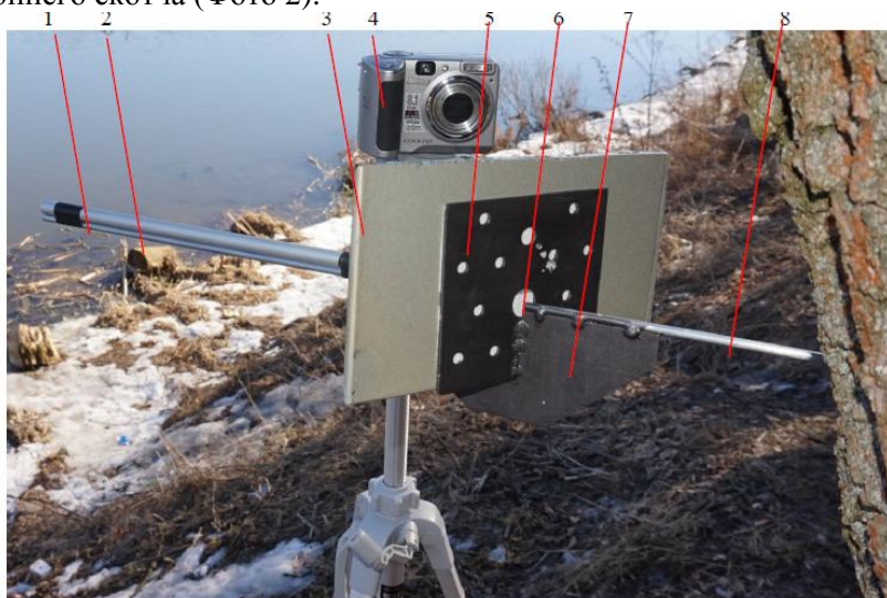
Фото 2. Установка приспособления для визирования линии полета пули: 1 – визирующая трубка; 2 – выходная спица; 3 – зеркало; 4 – фотоаппарат на штативе; 5 – пластина; 6 – отверстие для проверки соосности спиц; 7 – основание; 8 – входная спица.
