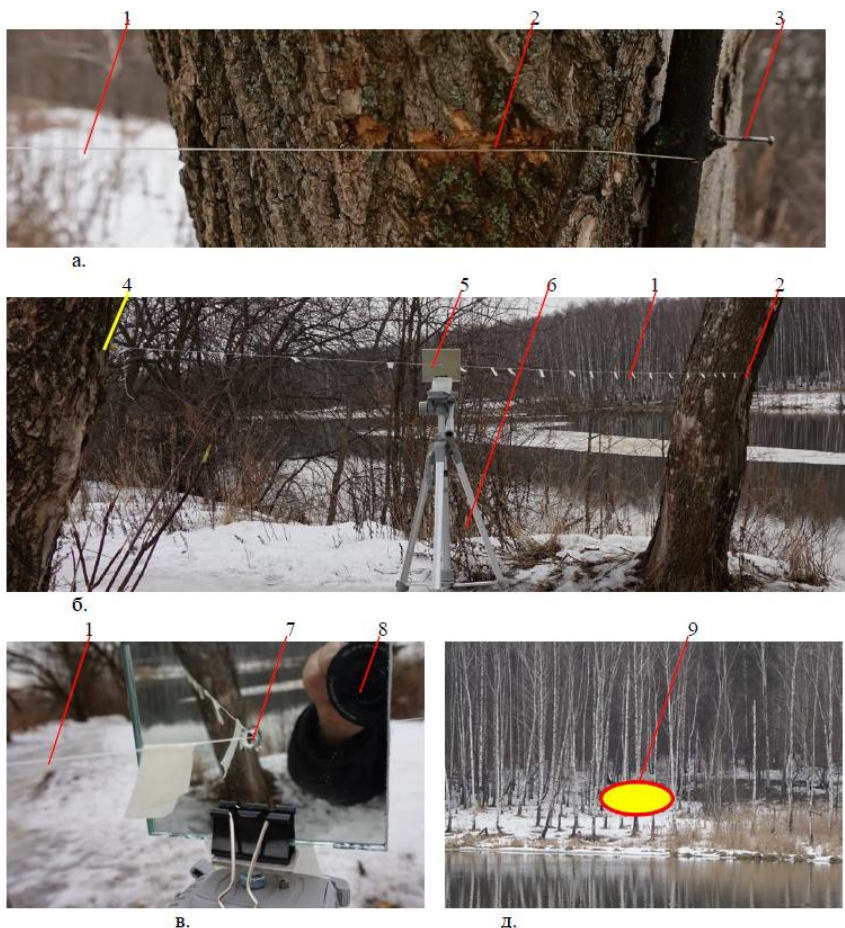
Фото 5. Визирование с использованием нити и зеркала по двум пробойнам: а – касательная пробоина на первом дереве; б – общая схема визирования; в – фотографирование результатов визирования; д – ориентирующая фотография с указанием результата визирования: 1 – нить; 2 – касательный след пули; 3 – место крепления нити; 4 – слепая пробоина во втором дереве; 5 – зеркало с отверстием в центре; 6 – штатив; 7 – отверстие в зеркале; 8 – фотоаппарат; 9 – участок местности, с которого был произведен выстрел.
