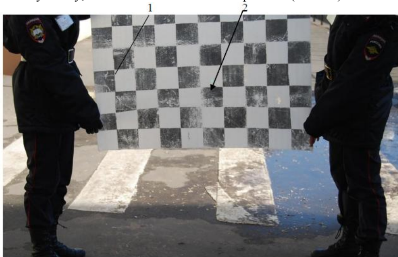
Фото 5. Использование экрана для визирования с помощью лазера: 1 – экран; 2 – точка луча лазера.
