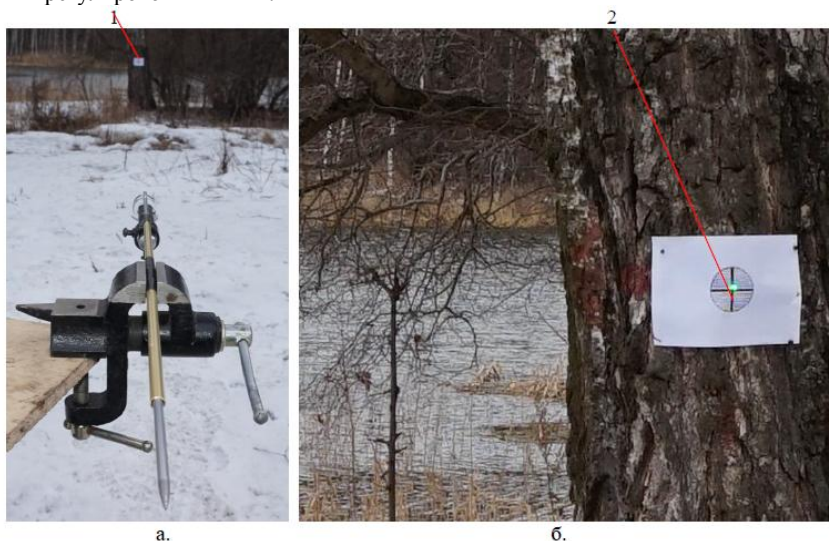
Фото. 3. Выверка лазерного луча по удаленной точке: а – наведение стальной спицы и лазерного луча на удаленную (25 метров) точку; б – совмещение оси стальной спицы и лазерного луча: 1 – удаленная точка; 2 – точка луча лазера.
