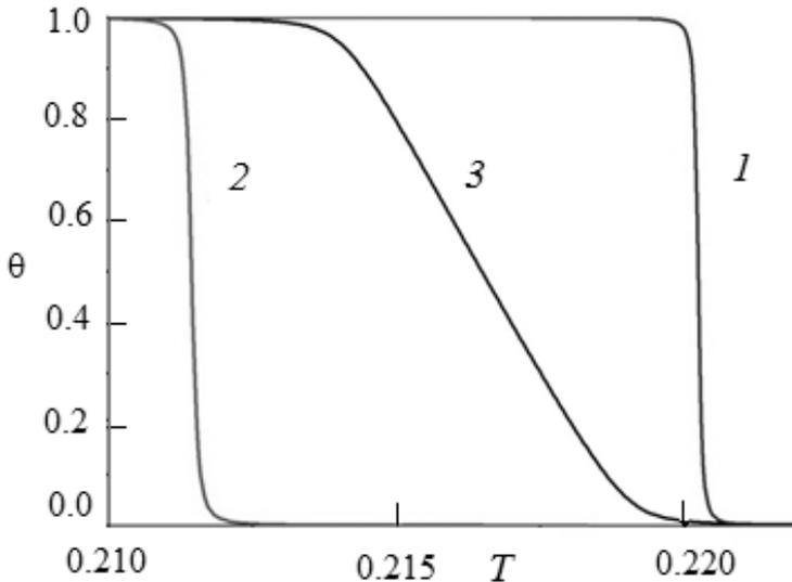
**Рис. 1.** Кривые зависимости степени спиральности  $\theta(T)$  от температуры  $T$  при следующих параметрах теории:  $Q_A=71$ ,  $Q_B=51$ ,  $U_A=1$ ,  $U_B=0.8$ ,  $x=0.4$  и  $\Delta=4$ : 1 – кривая плавления для гомополимера  $B$ , 2 – кривая плавления для гомополимера  $A$ , 3 – кривая плавления для гетерополимера, состоящего из мономеров  $A$  и  $B$ .
